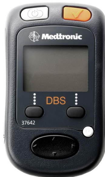
12. ábra: Az orvosprogramozó (bal) és betegprogramozó (jobb). Az orvosprogramozóval az összes stimulációs paraméter állítható, a betegprogramozóval csak az amplitúdó.
